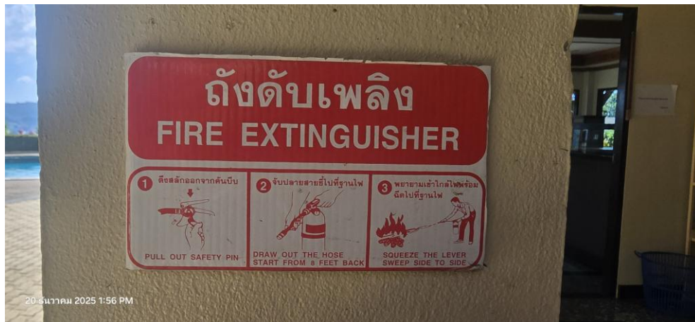
ภาพที่ 14 วิธีการใช้ถังดับเพลิง
